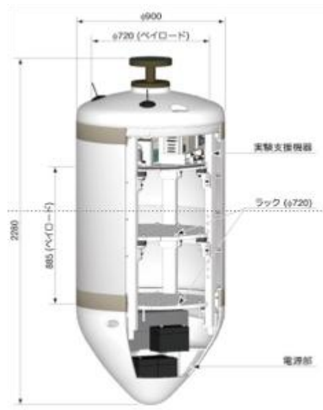
図2 砲弾型落下カプセルの概念図（無重量研究センターのWEB ページから）
